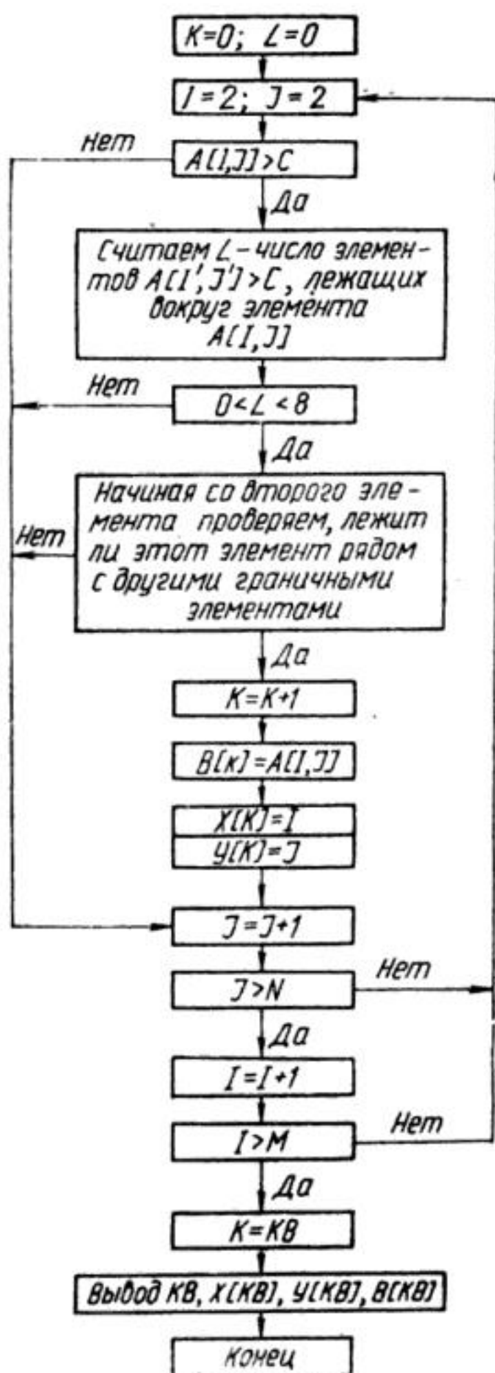
Рис. 2. Блок-схема алгоритма выделения контура изображения.
