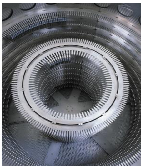
Рисунок 6.4. Внутрішній об'єм низькотемпературного сховища з комірками для автоматичного роботизованого розташування холдерів з кріоконсервованим біоматеріалом.
