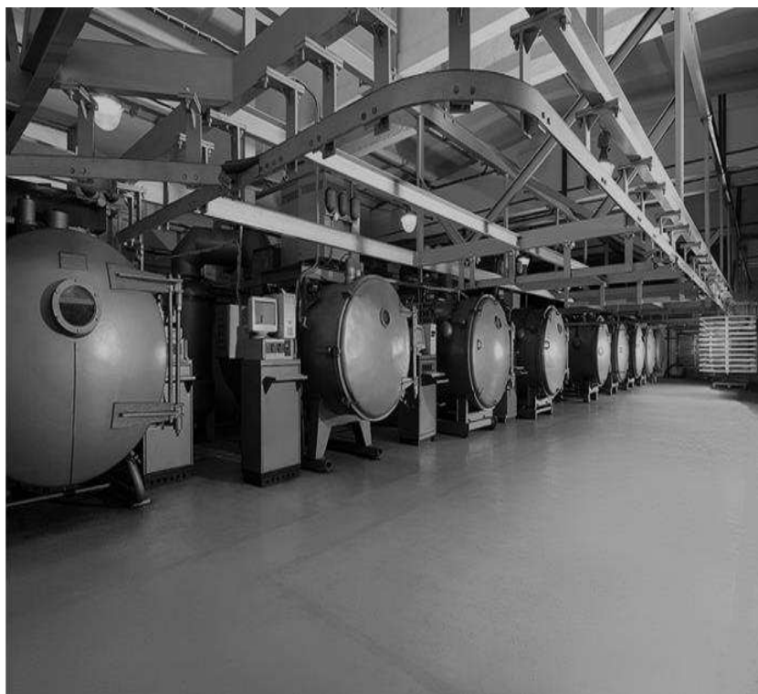
Рис. 8. Промислова лінія сублімаційної сушки з виробництва продуктів харчування ТД «Мазурін» (РФ). До початку 2017 року в асортименті компанії налічувалося понад 60 видів продуктів сублімаційної сушки власного виробництва.
