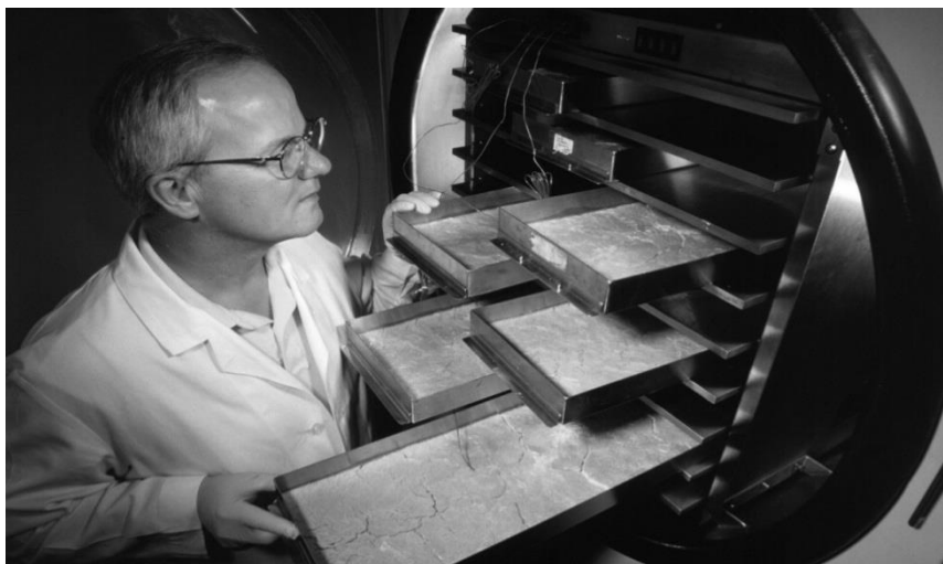
Рис. 3. Приклад розміщення на полицях матеріалу, що підлягає сублімації.
