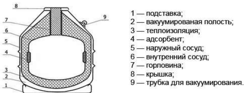
Рис.15.8. Схема строения сосуда Дьюара ( https://ru.wikipedia.org/wiki/сосуда Дьюара )
