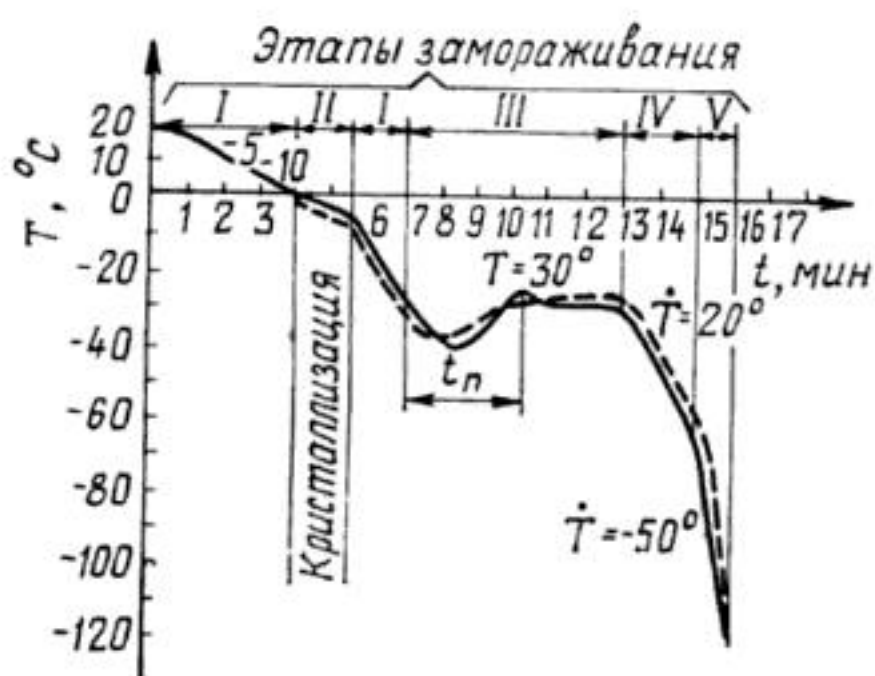
Рис. 4. Графики процесса изменения температуры биоматериала в контейнере при физическом моделировании; u_{ШИМ} = 0,3 В, c1 = 1 мкф, c2 = 0,22 мкф, — физическая модель, --- математическая модель.
